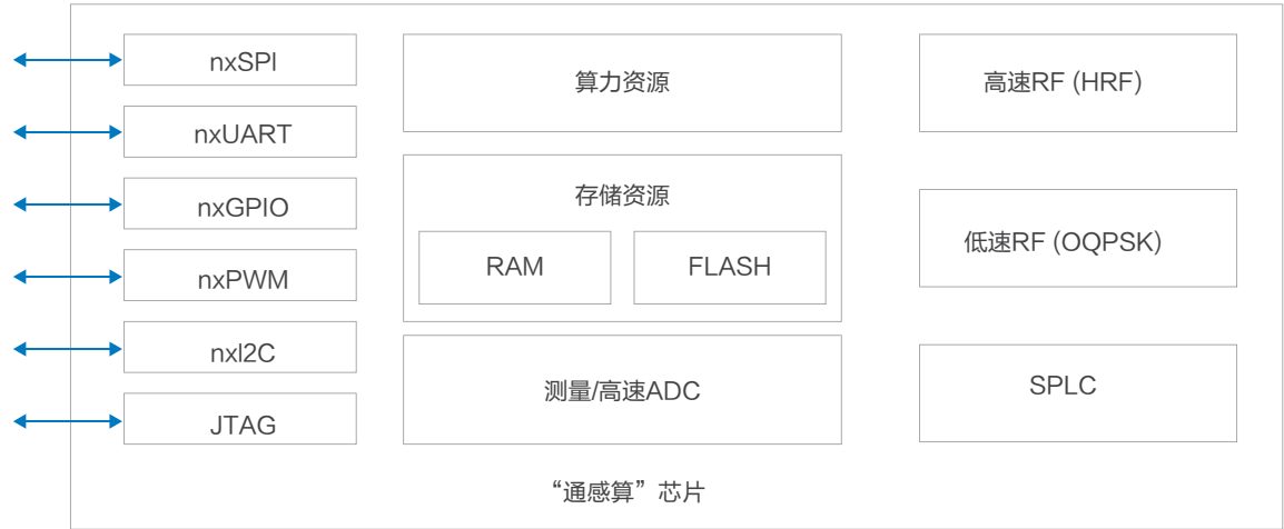
图 4-29 通感算控一体化芯片架构示意图
