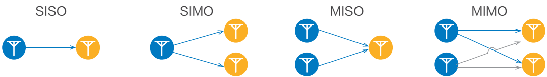
图 4-5 不同 MIMO 形式示意图
