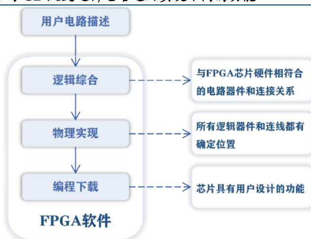
图表35: 编程 LC 与 SB 改变逻辑电路进而实现不同的功能
