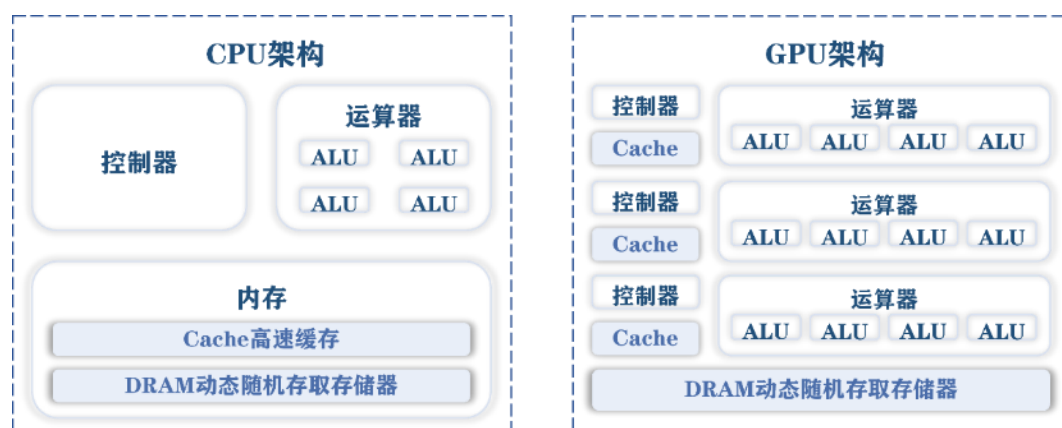
图表27: GPU 相比 CPU 架构更重视并行计算
