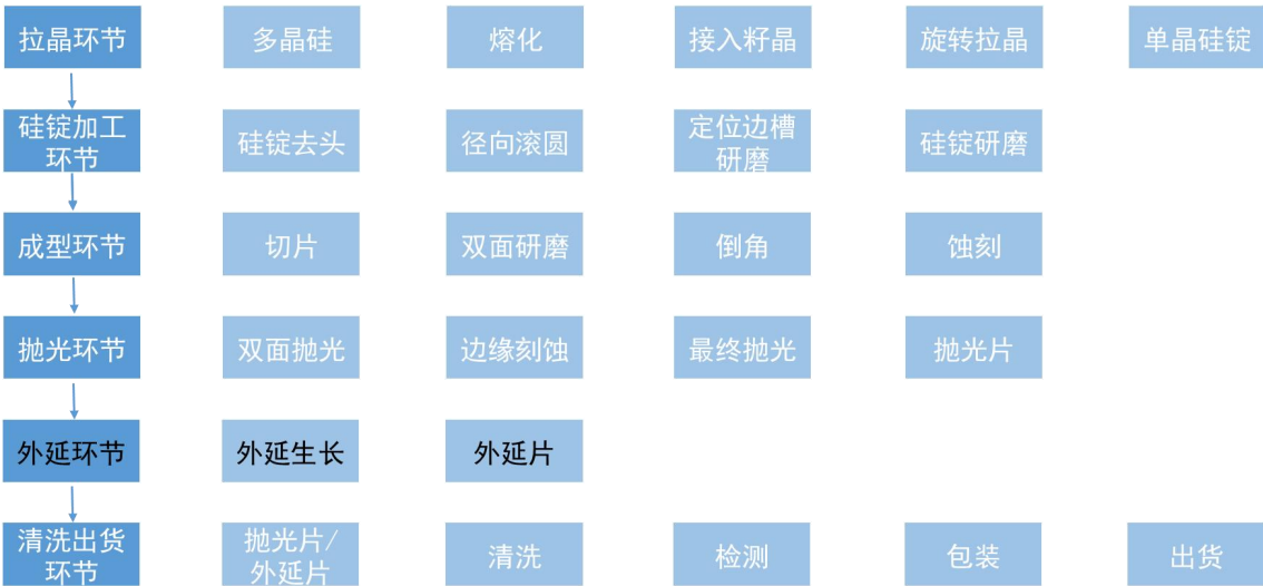
图：半导体抛光片、外延片工艺流程图
