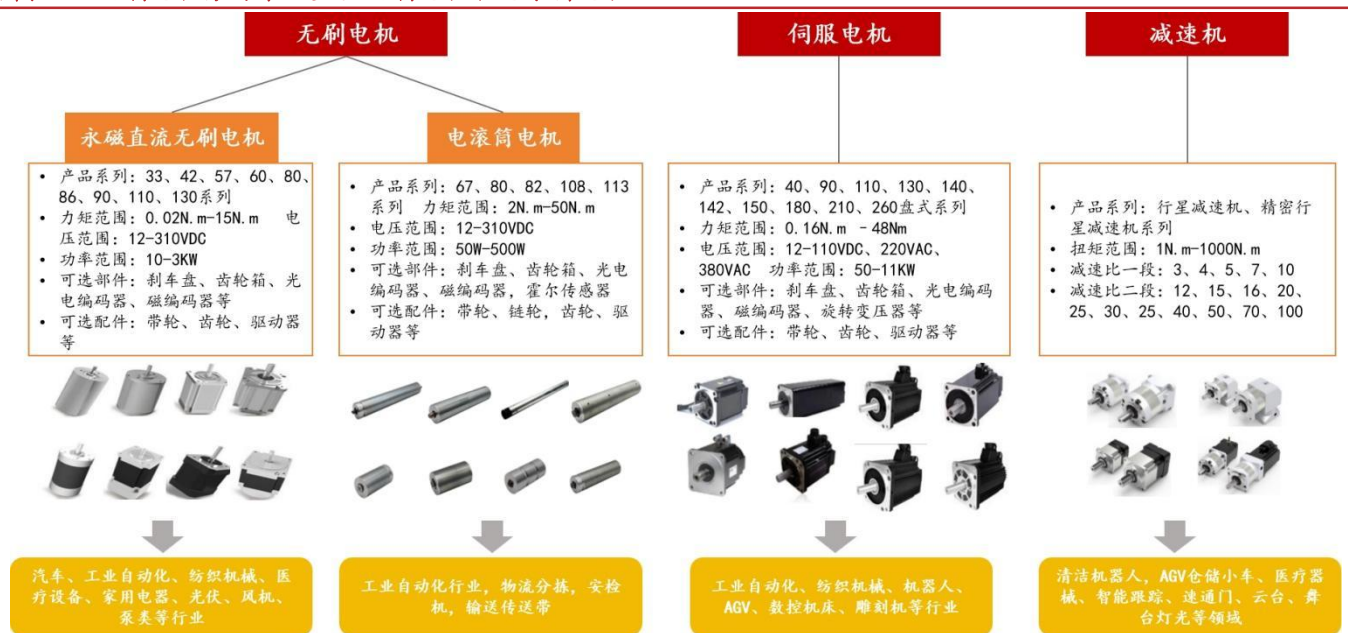
图表 9：无刷电机分为永磁直流无刷电机和电滚筒电机
