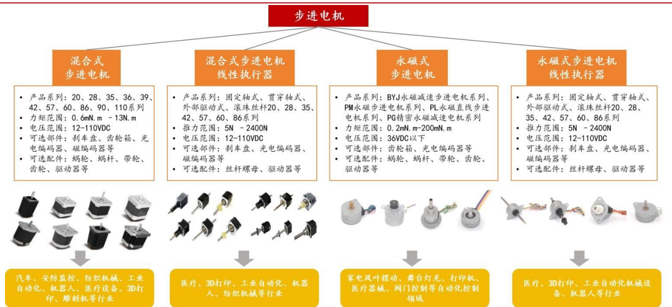
图表 8：步进电机分为混合式步进电机及执行器和永磁式步进电机及执行器
