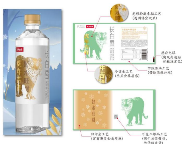
图表 28：农夫山泉长白山雪虎年限量版矿泉水标签工艺示意图
