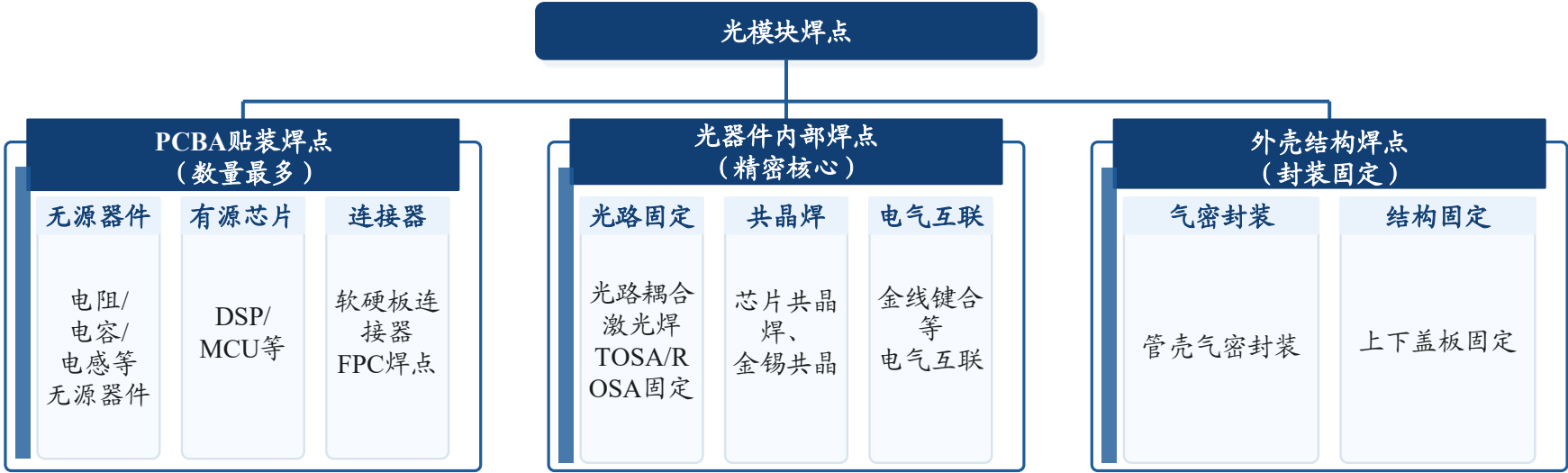
图：光模块焊接/互联环节拆解
