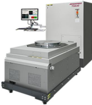
图26：以爱德万 T5830 系列为例，并行测试能力高达 2304site（晶圆测试）/768site（成品测试）
