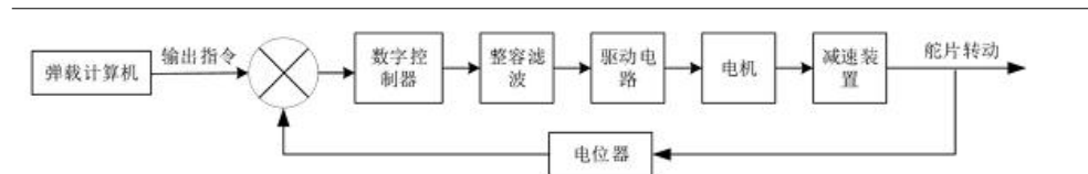
图 22：弹载舵机系统工作原理图
