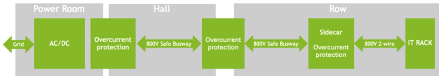
图表6: Kyber 采用 800VDC 高压直流供电架构, 大幅提升能效并降低供电环节空间占用
