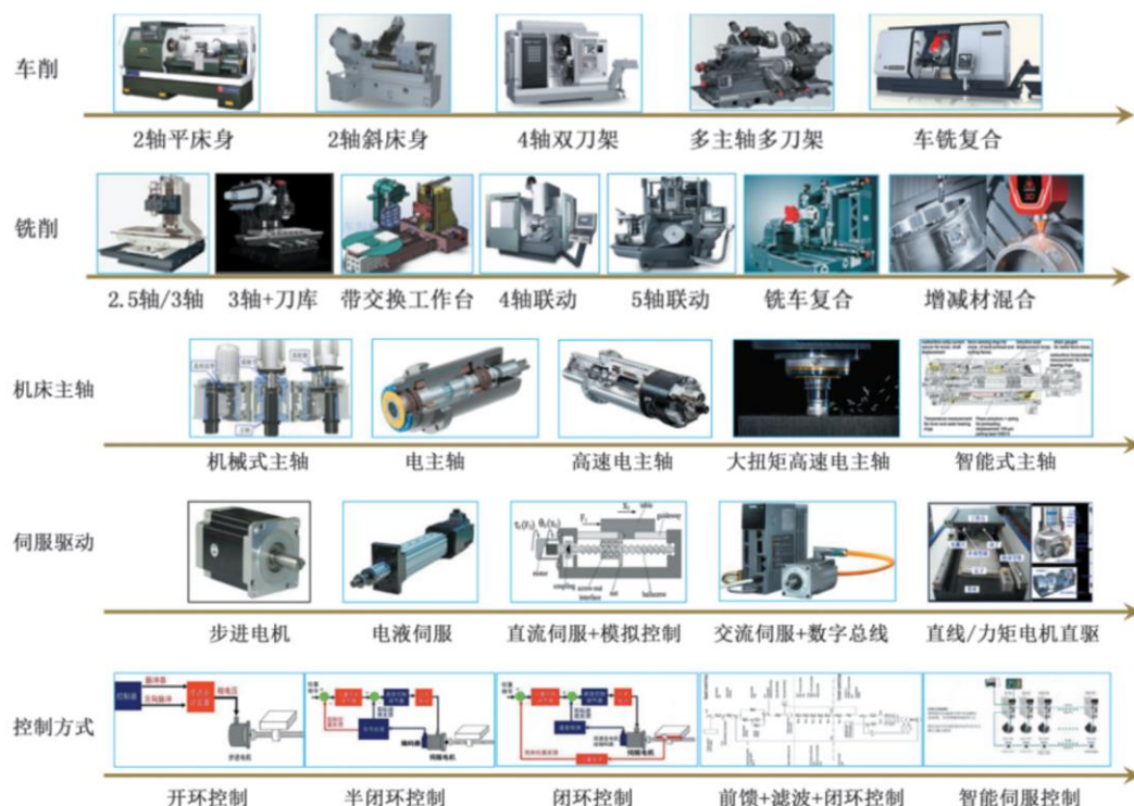
图表3：机床技术升级体现在机床结构、主轴、驱动、控制等方面
