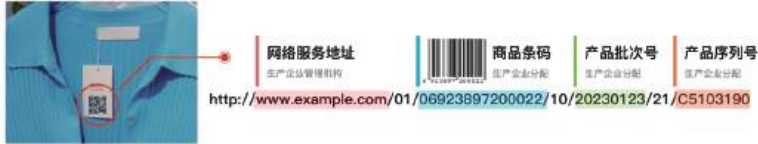
图24 纺织产品数字护照二维码结构示意图(以GS1 DL URI为例)
