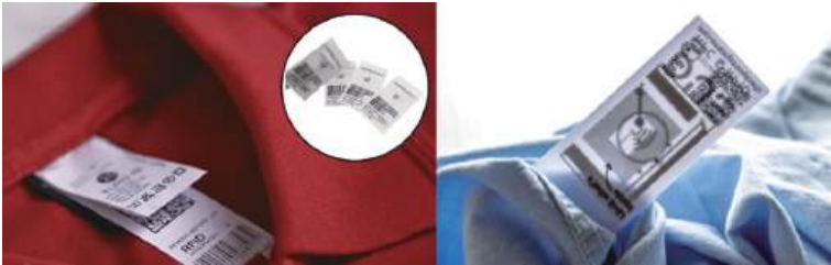
图25 在服装中应用NFC/RFID标签载体的示例 (来源：Encstore.com & Checkpoint.com)
