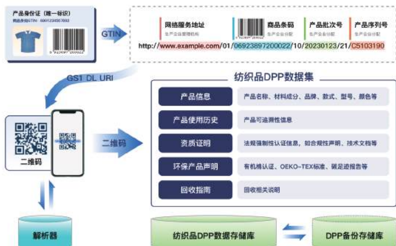
图26 链接纺织产品数字护照数据集的示意图（以GS1 DL为例）
