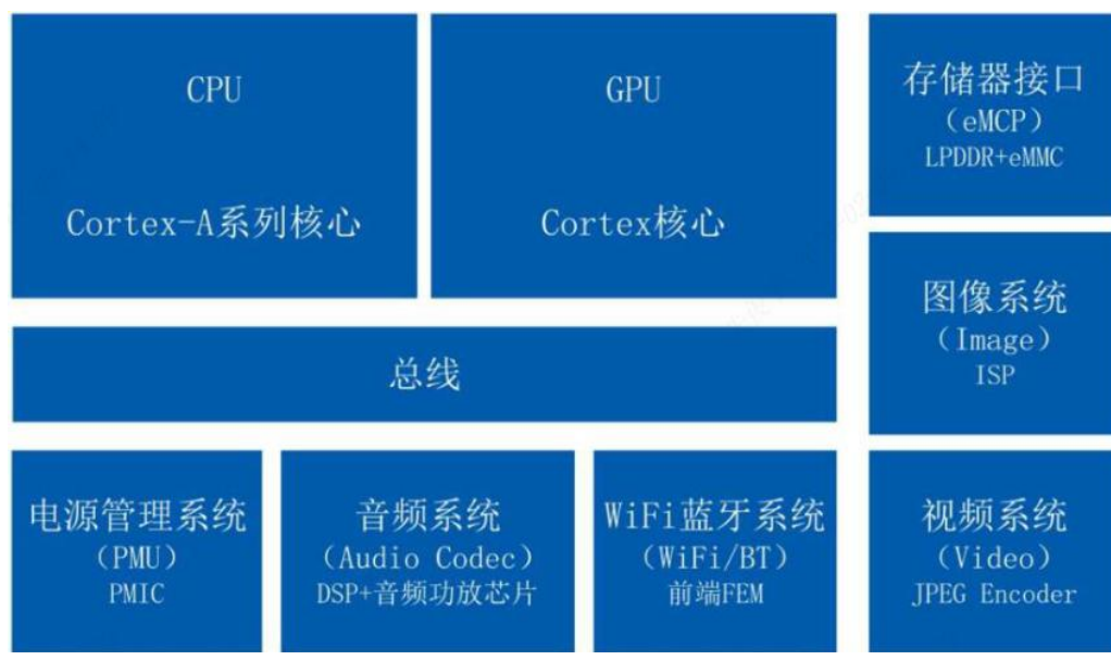
图表 15：系统级 SoC 方案结构图
