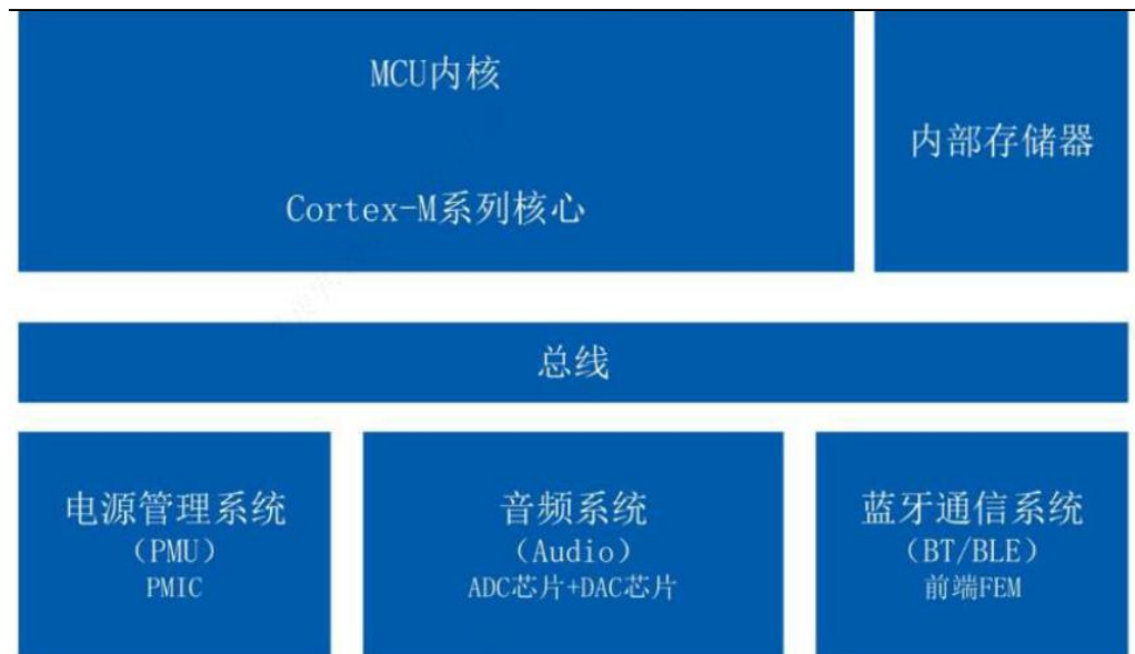
图表 16：MCU 级 SoC 结构图
