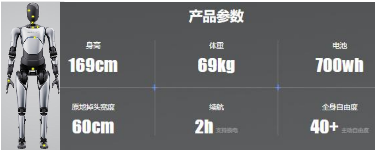
图21：智元远征 A2交互服务机器人产品参数
