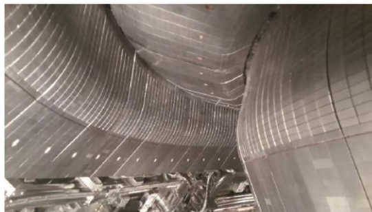
图 29：ITER 钨串水冷偏滤器
