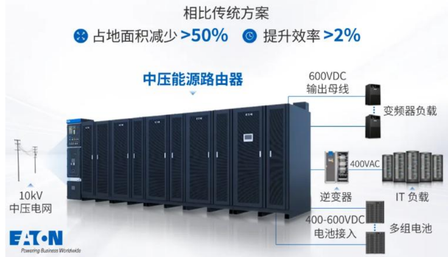
图16：伊顿 MVSST 数据中心应用场景实例
