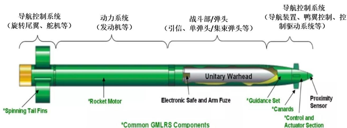
图 13：远程火箭弹主要由制导控制系统、动力系统与战斗部组成
