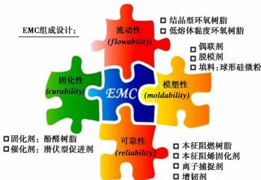
图表3：先进封装用 EMC 的组成设计及开发要点
