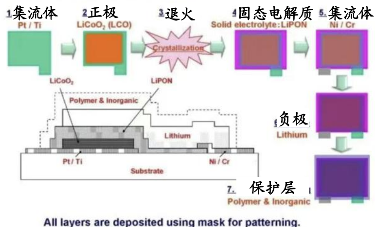
◆ 图：ULVAC多层沉积结构流程图
