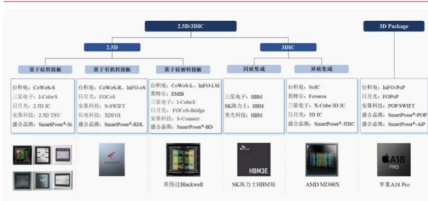
图 63：芯粒多芯片集成封装的部分代表性技术平台和芯片产品
