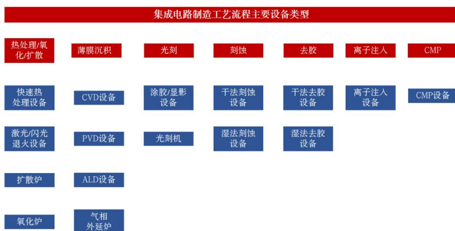
图 45：集成电路制造工艺流程及主要设备
