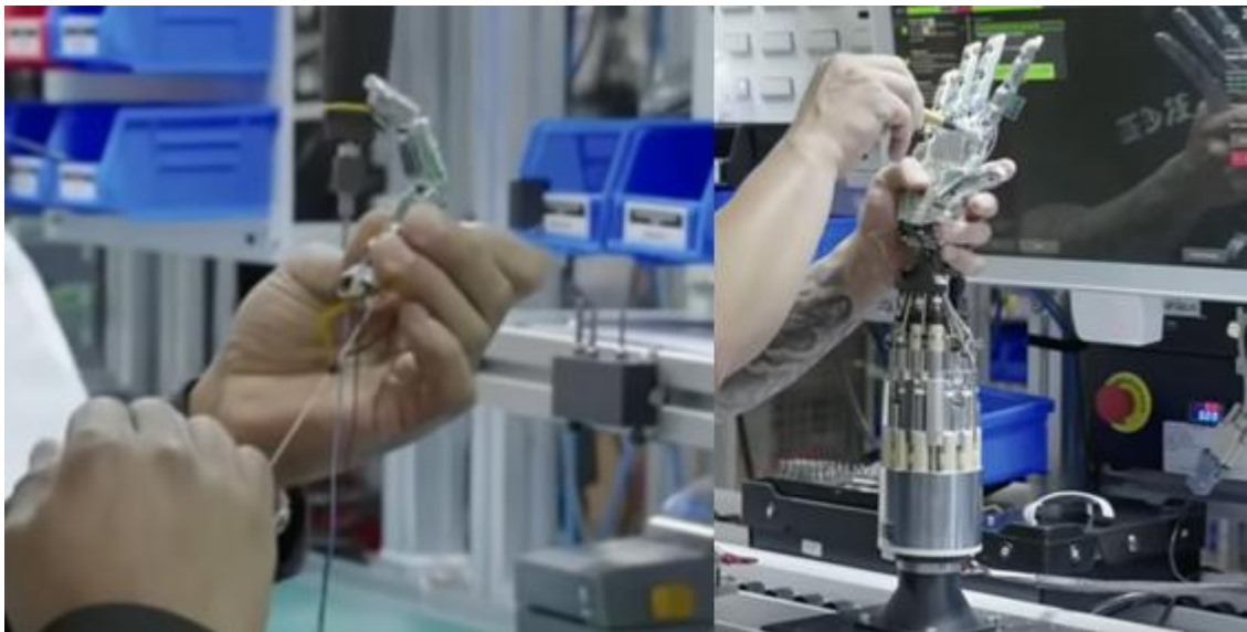
图 37：Optimus Gen3 生产线上灵巧手调试情况
