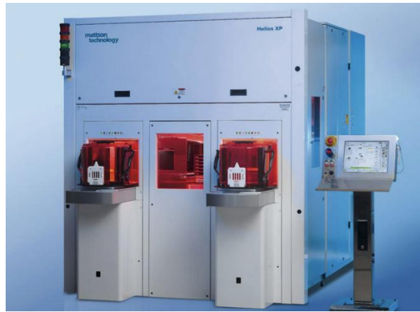
图29: Helios®系列快速热处理设备
