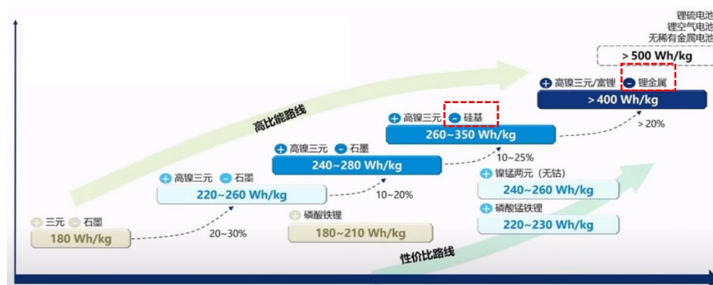
图表 4：负极材料未来迭代方向是硅基/金属锂，膨胀性更大
