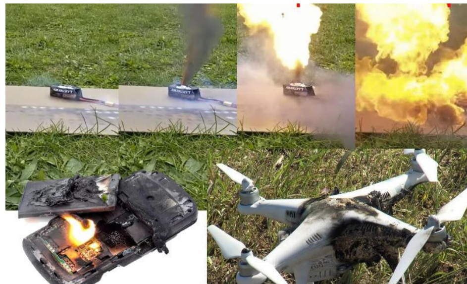
锂电池热失控造成航空器着火发生火灾
