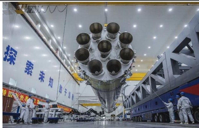
图4：天鹊-12A 液氧甲烷发动机 9 机并联
