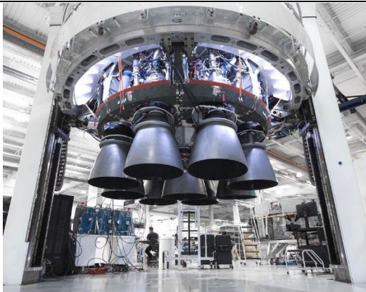
图3：猎鹰 9 一级助推器的后端搭载九台梅林 1D 发动机
