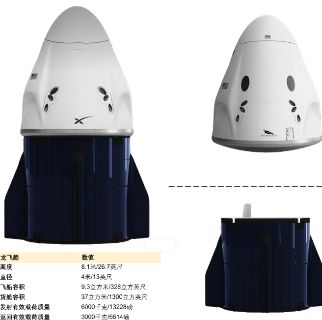
图表15：龙飞船-两段式结构设计
