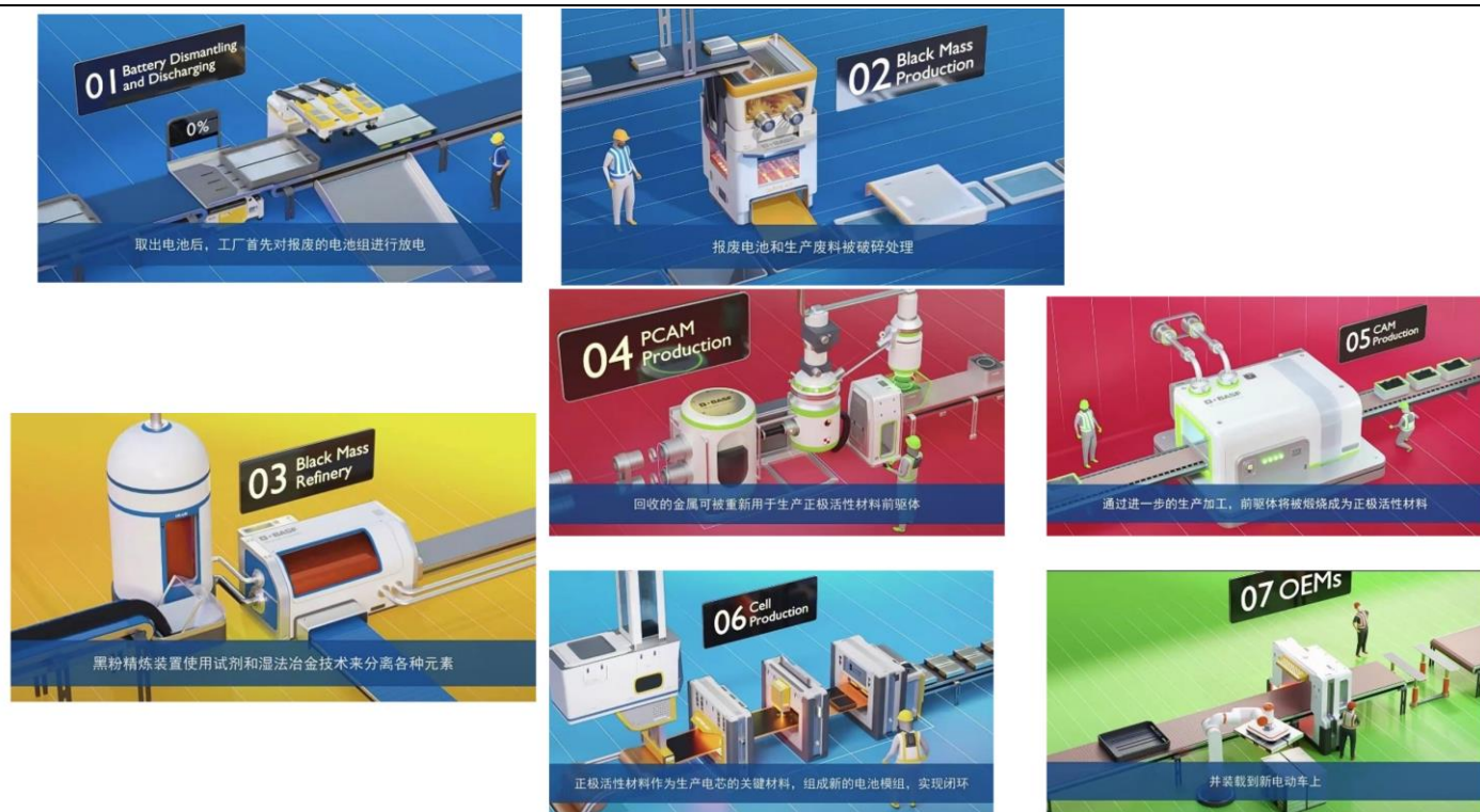
图10：以巴斯夫的电池回收试验方案为例，需要经过放电、破碎、湿法冶金等工序
