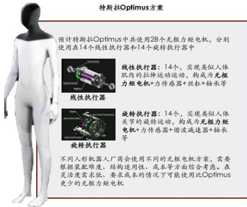
图10：无框力矩电机在人形机器人上用量更多、应用范围更广
