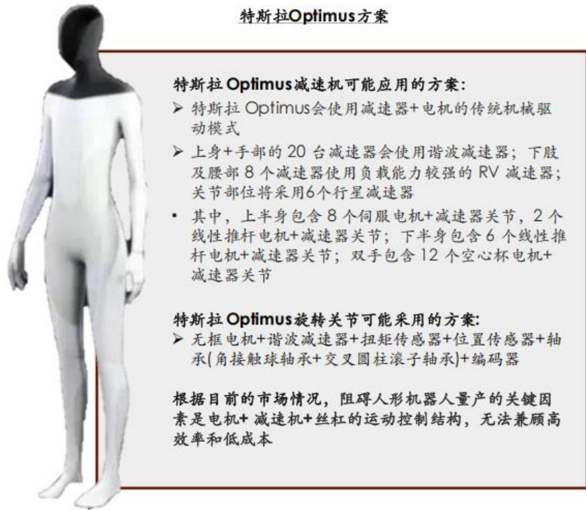
图9：人形机器人精密行星减速机主要应用于下肢关节部位，将采用 6 个行星减速机
