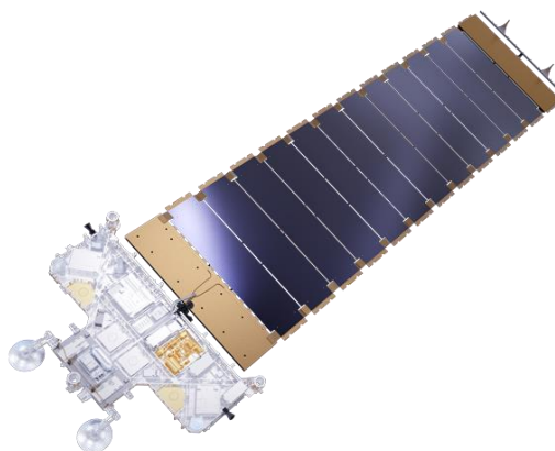
图12：银河航天自主研发了二代通信卫星 1.0 - 平板可堆叠卫星
