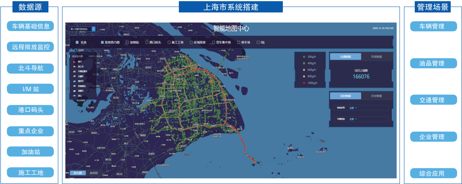
图 4-1 重型柴油车排放大数据智慧监管系统
