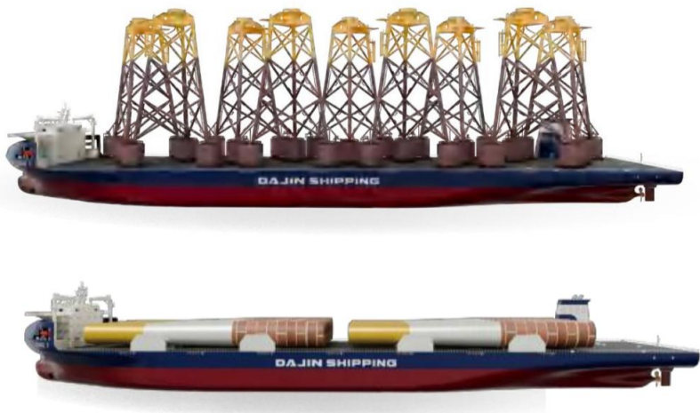
图42：大金重工自主研发的重大件特种运输船
