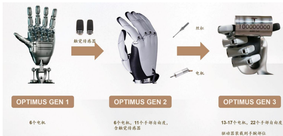
图：第一代到即将发布的第三代特斯拉灵巧手的方案变化
