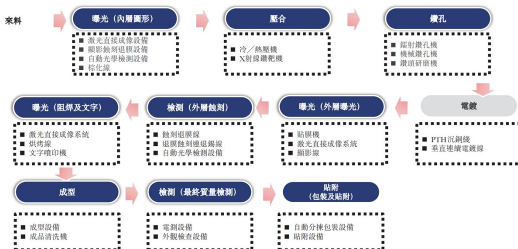
图表 5：公司产品体系覆盖钻孔、曝光、压合、成型及检测等几乎所有 PCB 生产主要工序
