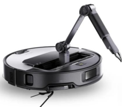
图5 石头科技 2025CES 发布了搭载仿生机械手的扫地机器人
