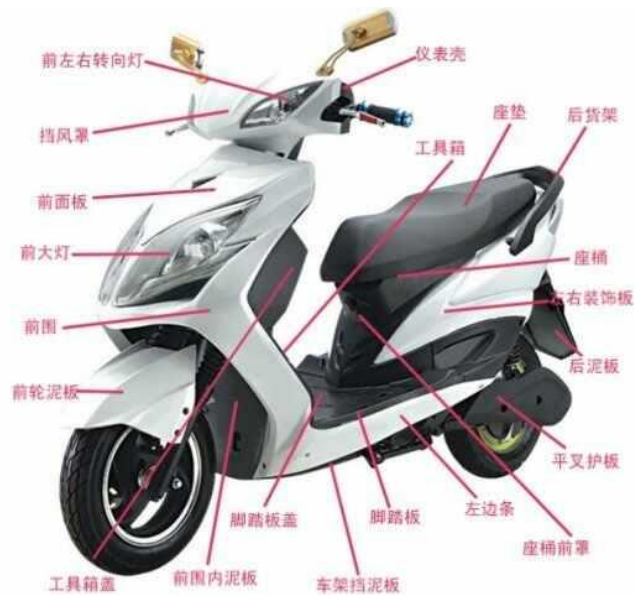
图15：电动自行车结构拆解图（其中大多数可以使用钨微合金做替代）
