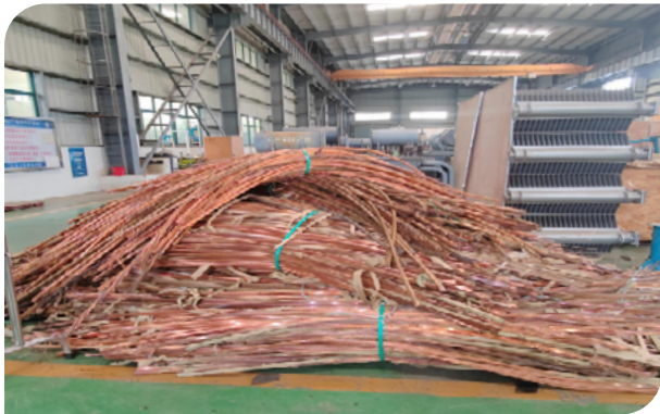
电缆拆解出可回收的再生资源
