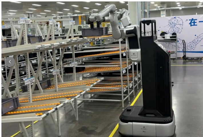
图 4：智元远征 A2-W 在富临精工工厂上料
