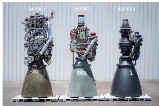
图表9：第三代猛禽发动机通过 3D 打印工艺，将前两代的多零部件整合为一
