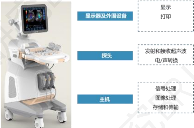
图表 2 医疗彩超设备的组成结构
