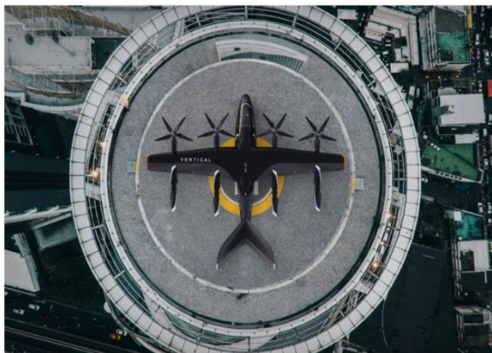
Vertical Aerospace VX4 机身大量采用轻量化复合材料
