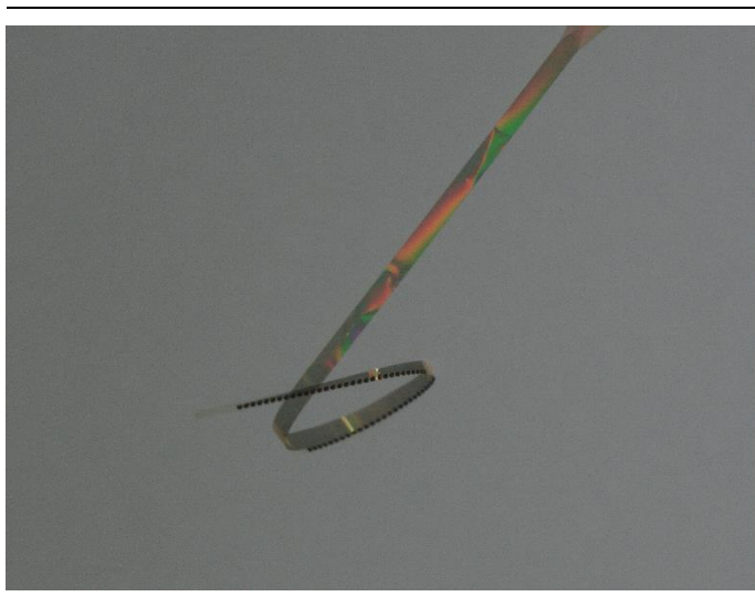
图18：超柔性电极约为头发丝的 1/100
