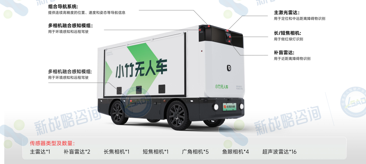
图表 4-4：佑驾创新无人配送车全车规感知方案
