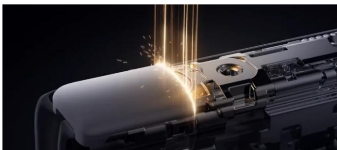
图88: 荣耀 Magic V2 铰链轴盖采用钛合金 3D 打印
