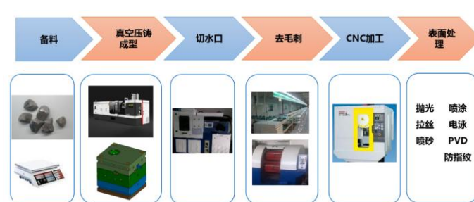
图100: 液态金属材料通过压铸成型
