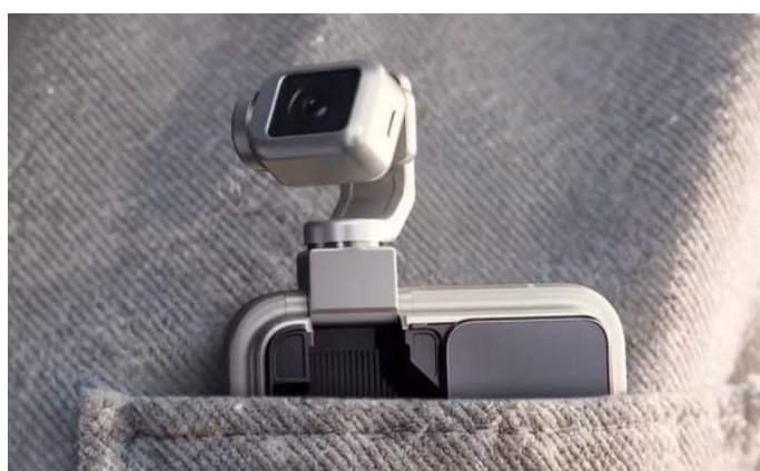
图70：荣耀 Robot Phone 通过机械结构能够追踪拍摄
