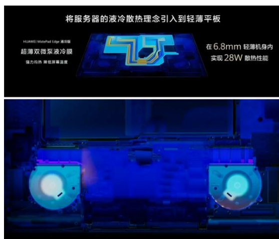
图81：华为 MatePad Edge 首次搭载微泵液冷技术
