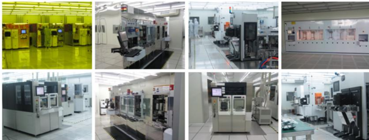
图：300毫米晶圆级TSV芯片尺寸封装量产线
