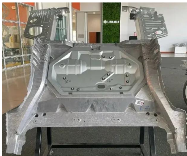
图表 16：特斯拉 Model Y 后底板采用热冲压一体成型，零件数从 70 个缩减至 1 个，减重 10%
