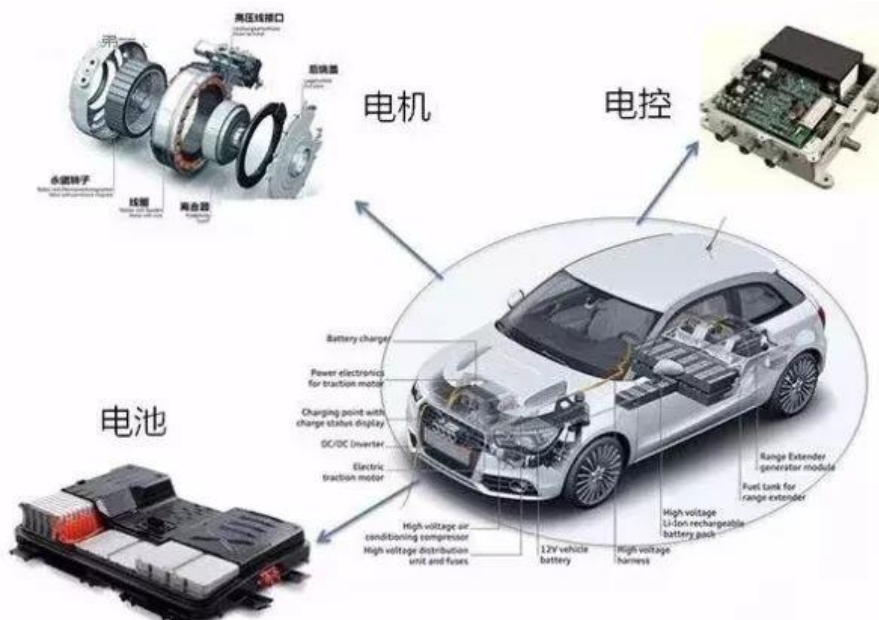
图表 7：电池、电机和电控成为新能源汽车三大核心零部件
