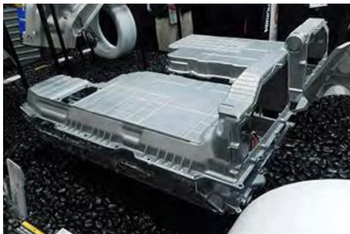
图表 15：一体化压铸可以实现电池壳体的高度集成
