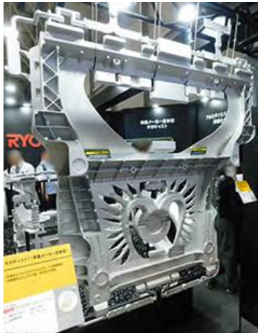
图表 14：一体化压铸可以实现车辆后底架的高度集成
