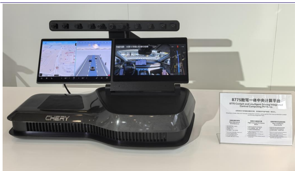
图表 154：德赛西威与奇瑞联合开发的“8775 舱驾一体中央计算平台”
