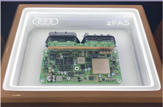
图表 30：奥迪新 A8 车型搭载的 zFAS
