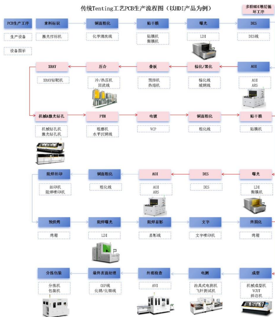
图表9: PCB 生产流程图
