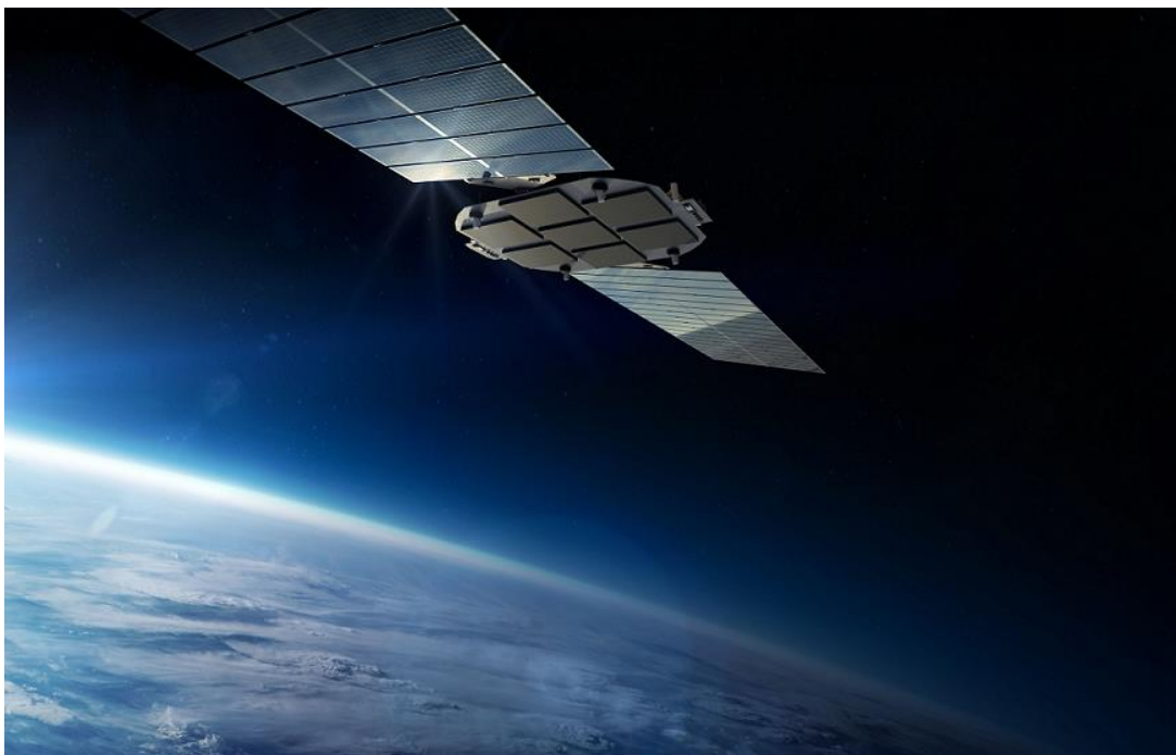
图表33: Flatellite 采用低矮平板结构，可在 Neutron 整流罩内高密度堆叠
