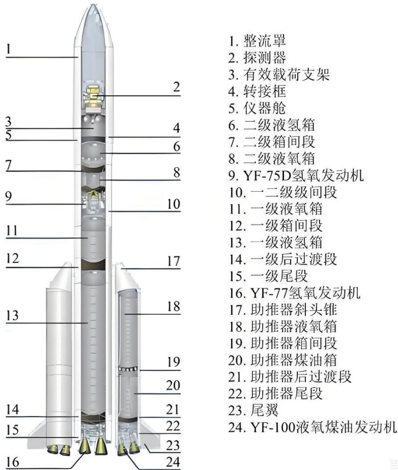
图：液体火箭箭体结构示意图
