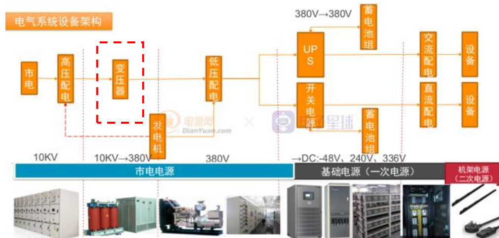
图16：数据中心供配电系统示意图
