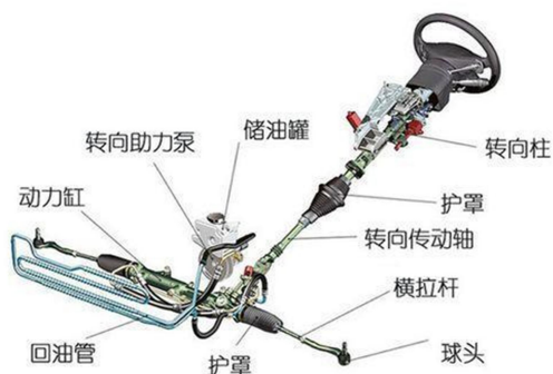
图11: 机械液压助力转向系统构造图
