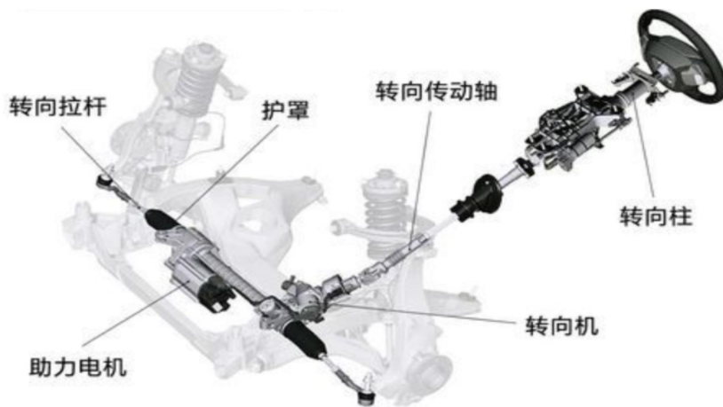
图14: 电动助力转向系统构造图
